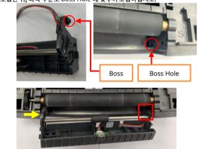
7. Printer 바닥 면이 정면으로 향하게 하십시오. Hook(빨간색 원)를 내측 방향으로 눌러 Cover DIP 을 분리하고 Peeler Wire 를 하기 그림과 같이 보이게 정형하십시오. ※ 다른 Wire 와 꼬이지 않게 정형 하십시오.
